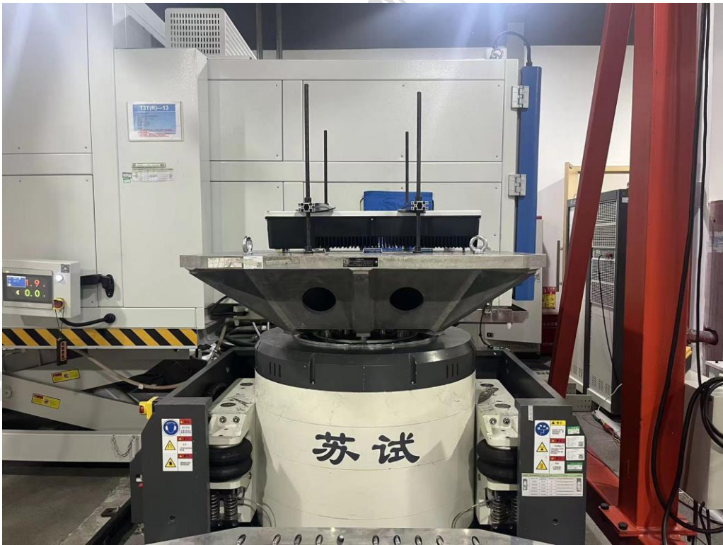
EUT-1 Z 轴向随机振动（裸机）、正弦振动（裸机）固定照片
