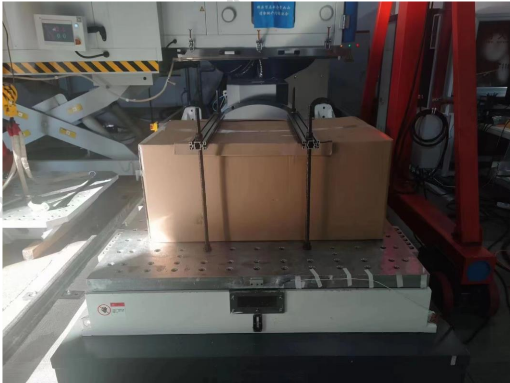
EUT-1 X 轴向随机振动 (包装) 固定照片
