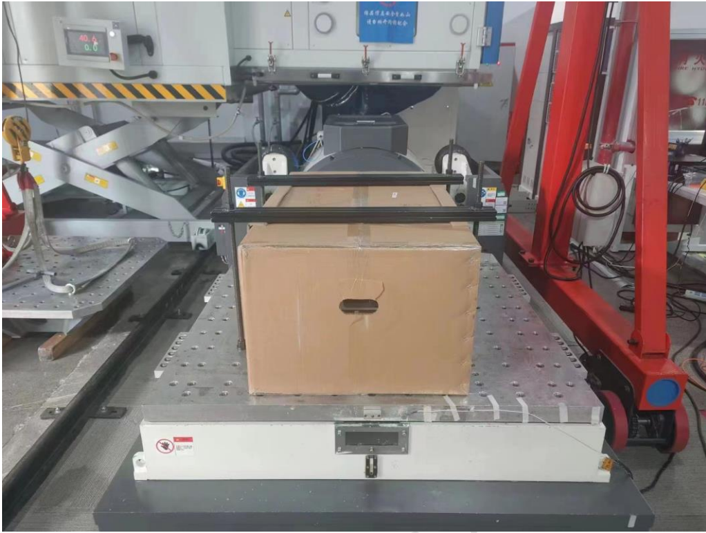
EUT-1 Y 轴向随机振动（包装）固定照片
